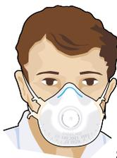
Les appareils de protection respiratoire sont destinés à protéger contre les risques liés à l'inhalation d'un air chargé en polluants sous forme de gaz, de vapeurs, de poussières et ou d'aérosols, ou d'un air appauvri en oxygène.
